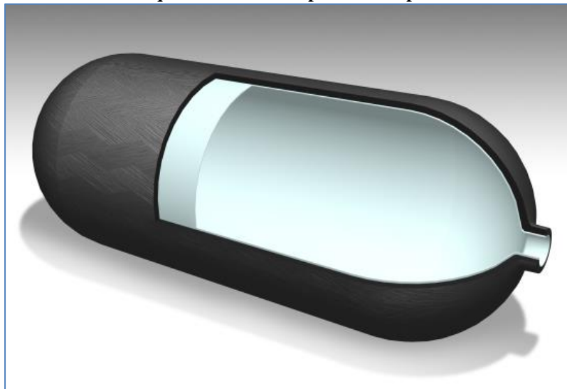
Ilustración 12 Tanque H2 de alta compresión con poliamidas
