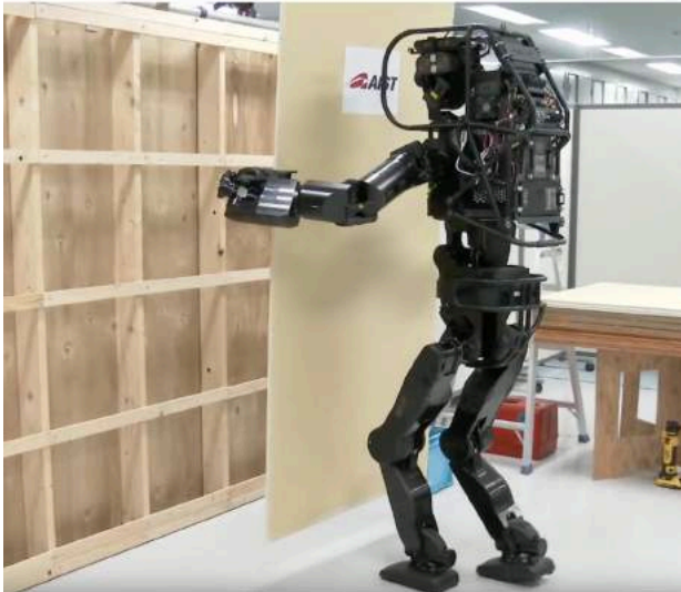
Robot aplicando yeso cartón sobre entramado liviano. AIST
