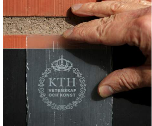
Madera transparente reemplazando lignina por resina. (Photo: Peter Larsson)
