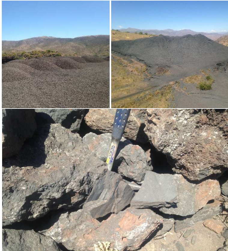
Figura 4.42: Muestra de gravilla (superior izquierda) y material fino de descarte de separación de óxidos de manganeso (superior derecha) y variedad de óxidos de manganeso de desmontes (inferior).
