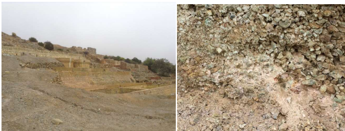
Figura 4.10: Izquierda: Foto general del estado de la Planta La Cobaltera. Derecha: Ripios de la planta La Cobaltera. Se observan precipitados de de eritrina, sulfatos de cobre y yeso.
