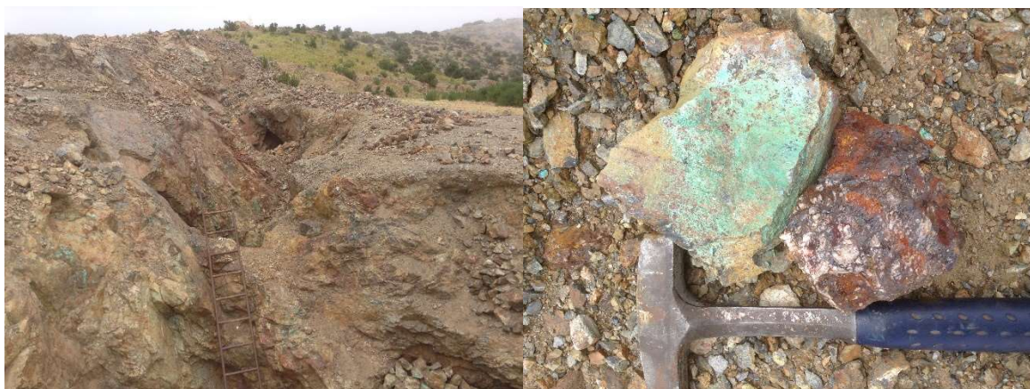
Figura 4.6: Foto de estructura mineralizada (izquierda) y muestras de rocas obtenidas desde el interior de la mina Fresia (derecha). Se observa oxidados verdes de cobre y muestra de magnetita con hematita e hidróxidos de hierro.
