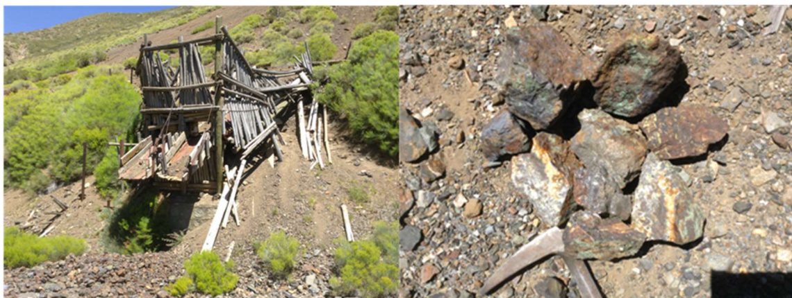
Figura 4.29. Labores abandonadas en mina Merceditas, sitio de toma de muestras (izquierda). Muestras de material de extracción con mineralización de sulfuros y oxidados verdes de cobre (derecha).
