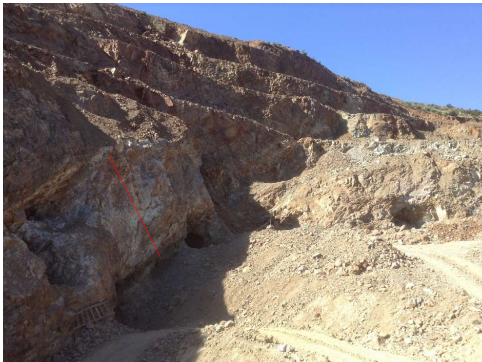
Figura 4.8: Foto del manto mineralizado de Mina Las Marengo. Se destaca manto mineralizado con una inclinación aproximada de 35° al noroeste. Línea roja indica potencia estimada de 5 a 10 m.
