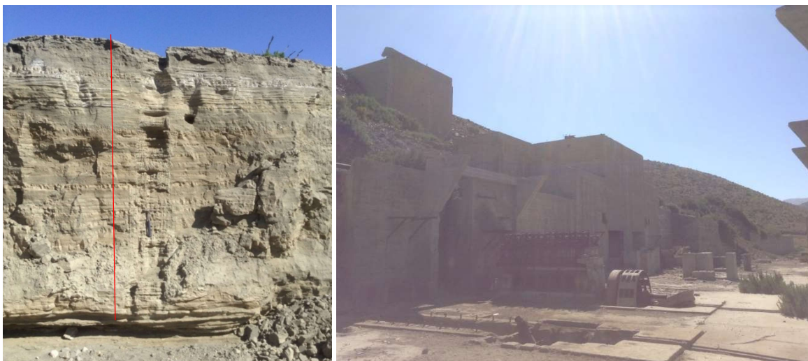
Figura 4.11Figura: Izquierda: Depósito de Relave de Planta La Quebradita, material muestreado para análisis. Línea roja indica espesor aproximado 4 – 6 m. Derecha: Foto general de la Planta Quebradita.
